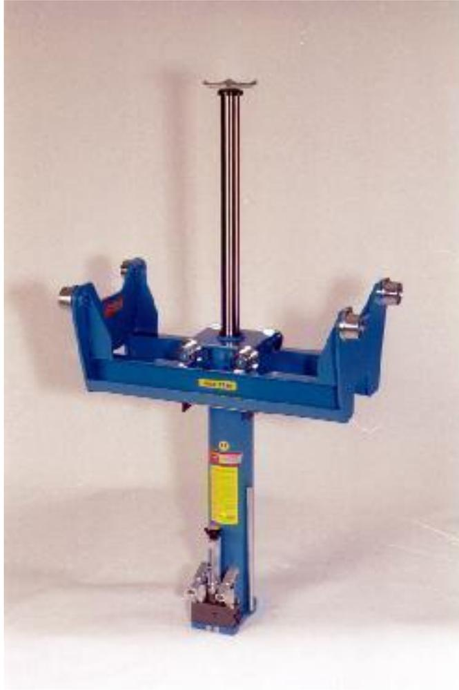
Grubenheber - pneumatischer Eilhub, handhydraulischer Lasthub, incl. auf Maß gefertigtem tiefgezogenem Fahrgestell
