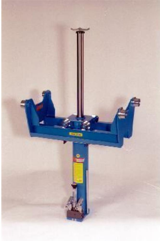
Grubenheber - pneumatischer Eilhub und Zwangsrückführung, handhydraulischer Lasthub, incl. auf Maß gefertigtem normalem Fahrgestell
